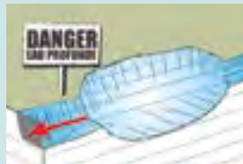
BASSIN DE SÉDIMENTATION
